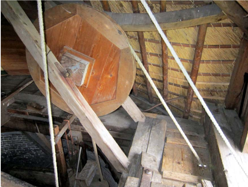
Afb. 10. Het vangwiel in de Pendrechtse Molen staat parallel aan het voeghout. (Foto auteur, 18 november 2017)
