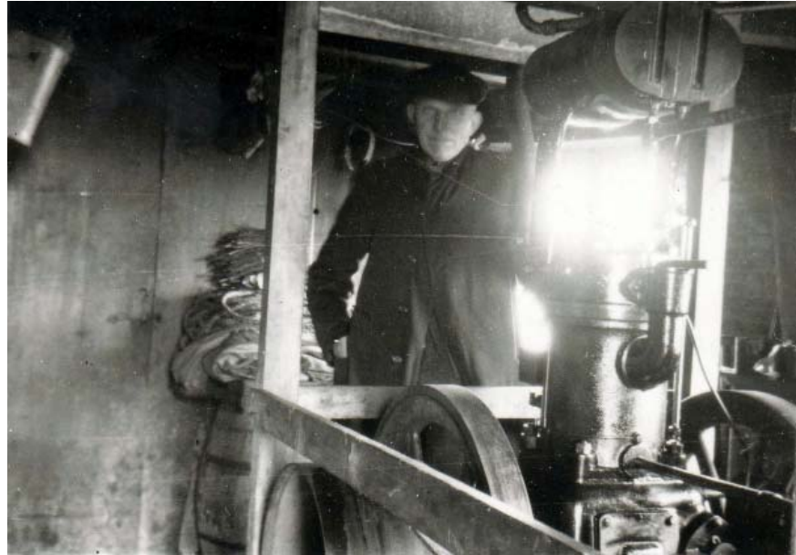
Afb. 1. Molenaar Leendert van der Weiden bij de dieselmotor uit 1924 in de voormalige woonkamer. Deze motor dreef met een riem een as buiten de molen aan en die was weer verbonden aan een centrifugaalpomp met eigen waterlopen. (Foto collectie auteur)
